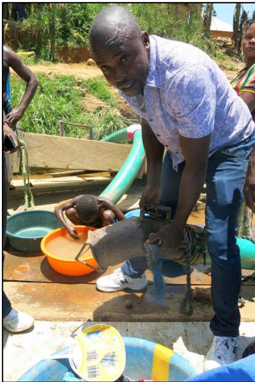
Fig. 8 Pointe du tuyau « suceur » qui est enfoncé dans les sédiments fluviaux par le plongeur
