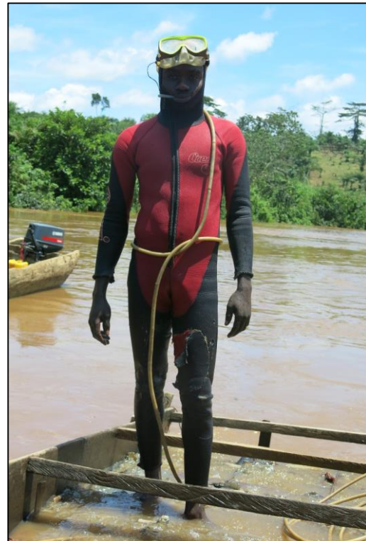
Fig. 9 Plongeur disposant d'un masque de plongeur, d'une combinaison néoprène, ainsi que d'un tuyau qui lui procure de l'oxygène moyennant un compresseur. Il plonge dans une profondeur de 4 à 12 m.
