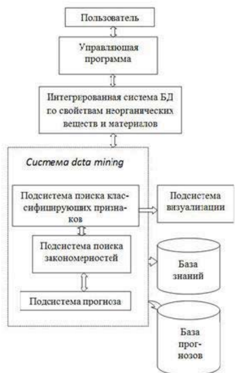
Рис. 1 1 Схема ИАС для поиска закономерностей в химической информации прогнозе новых соединений.
