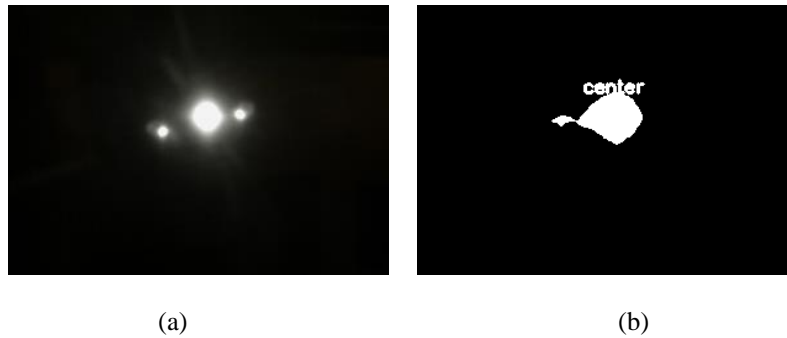
Fig. 4. Imagen adquirida por la cámara infrarroja antes (a) y después (b) de realizar el proceso de transformación a escala de grises, contraste e identificación del centroide
