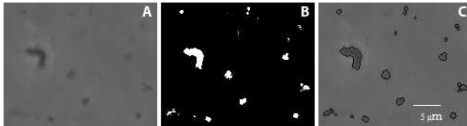
Abb. 1. Mikroskopiebild sedimentierter, agglomerierter Nanopartikel (AlOOH); A: Originalaufnahme; B: binärisiertes Bild; C: Originalaufnahme mit überlagerten Kante.
