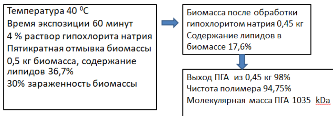
Рисунок 4- Масштабирование процесса экстракции гипохлоритом натрия.
