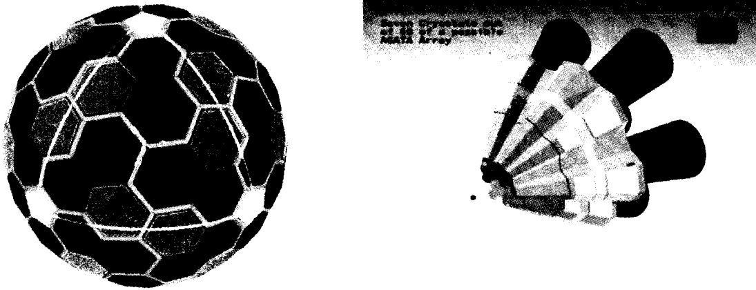
Figure 45: Gauche : vue schématique de la boule AGATA. Droite : module AGATA constitué de 7 cristaux.
