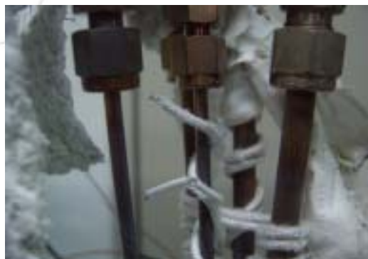
그림 16 히터의 열 손상 모습-3
