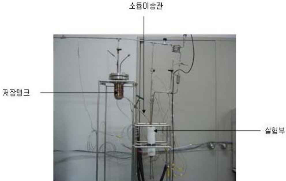
그림 7 개선 후 소듐이송유로의 모습
