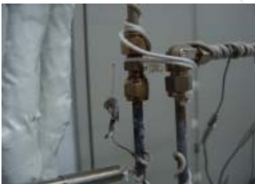
그림 15 히터의 열 손상 모습-2
