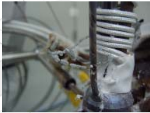
그림 14 히터의 열 손상 모습-1
