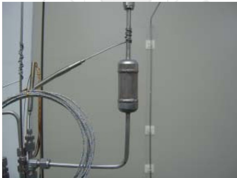
그림 10 Vapor trap의 설치도
