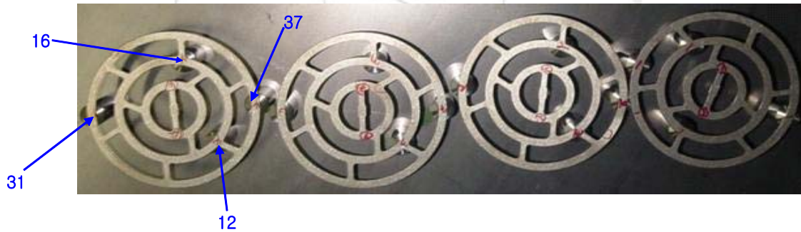
그림 3.2 돌출형 접합판을 이용한 토크시편 형상
