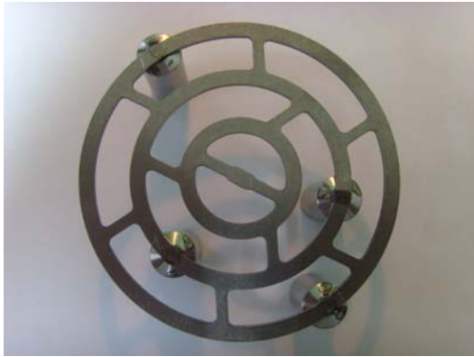
그림 3.7 돌출형 접합판을 이용한 토크시험용 용접시편 모습
