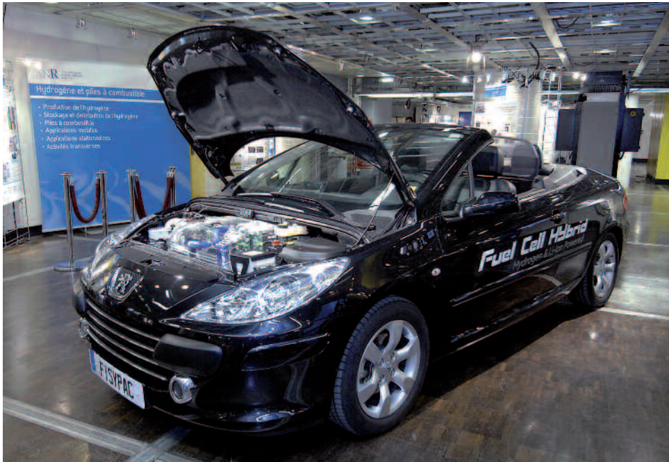
Voiture hybride équipée d'une pile à combustible fonctionnant à l'hydrogène et de batteries lithium-ion, développée dans le cadre du projet FISYPAC, coordonné par PSA Peugeot Citroën.
