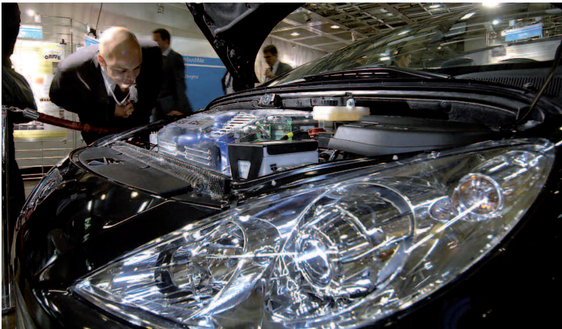
Pile à combustible développée dans le cadre du projet FISYPAC intégrée dans une automobile par PSA Peugeot Citroën
