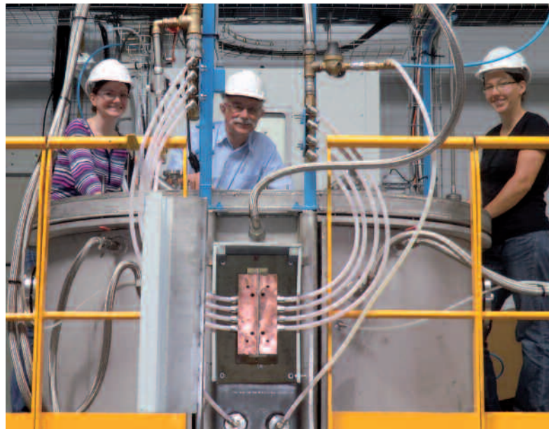
Creuset froid du pilote industriel décrit sur la partie gauche du schéma ci-dessous
