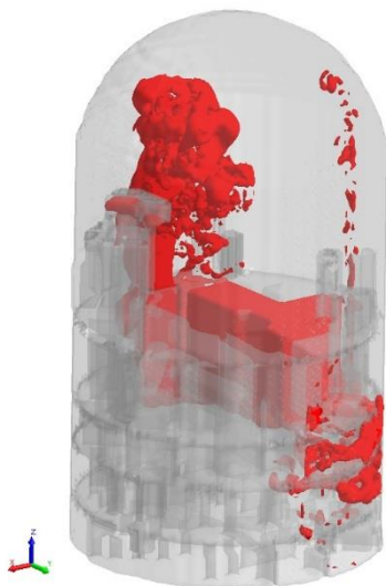
Рис. 2. Изоповерхность концентрации сгоревшей смеси
