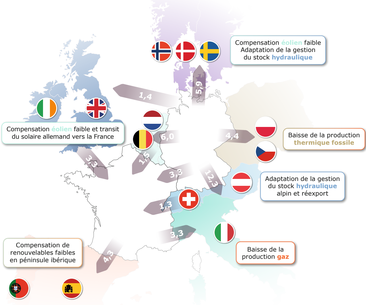
Figure 5.47 Flux aux frontières de la France et de l'Allemagne en milieu de journée lors d'une semaine de pic de production solaire en Allemagne combinée à une faible production éolienne en Europe du Nord et une faible production renouvelable en péninsule ibérique en 2030 (GW)
