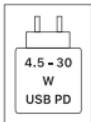
A3296 / A3290: A potência fornecida pelo carregador tem de estar entre o mínimo de 4,5 watts exigido pelo equipamento de rádio e o máximo de 30,0 watts para obter a velocidade máxima de carregamento.
