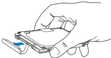
Il connettore è collegato a un cavo e rimane nell'alloggiamento dell'unità disco rigido.
