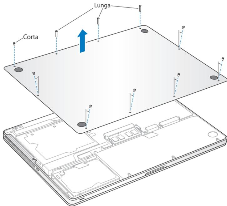
**Importante:** la rimozione dello chassis inferiore, determina l'esposizione di delicati componenti interni. Quando rimuovi o aggiungi un disco rigido, evita di toccare componenti diversi da quelli dell'assemblaggio del disco rigido.
