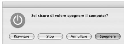
**Attenzione:** attendere alcuni secondi fino a quando la spia bianca sul monitor che indica lo stato di Stop non inizia a lampeggiare (segnalando che il computer è in stato di Stop e che il disco rigido è fermo) prima di spostare PowerBook. Se si sposta il computer mentre il disco rigido è in funzione, si potrebbe danneggiarlo, causando la perdita di dati o l'impossibilità di eseguire l'avvio dallo stesso disco rigido.
