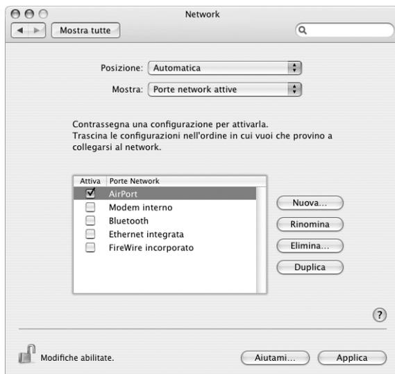
Quindi, seguire le istruzioni per configurare il network manualmente o utilizzando DHCP come indicato dall'ISP o dall'amministratore network. Se si configura il network, potrebbe essere più semplice configurarlo utilizzando DHCP, poiché il server assegna automaticamente gli indirizzi IP.
