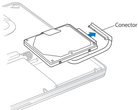
O conector está ligado a um cabo e permanece no compartimento da unidade de disco rígido.
