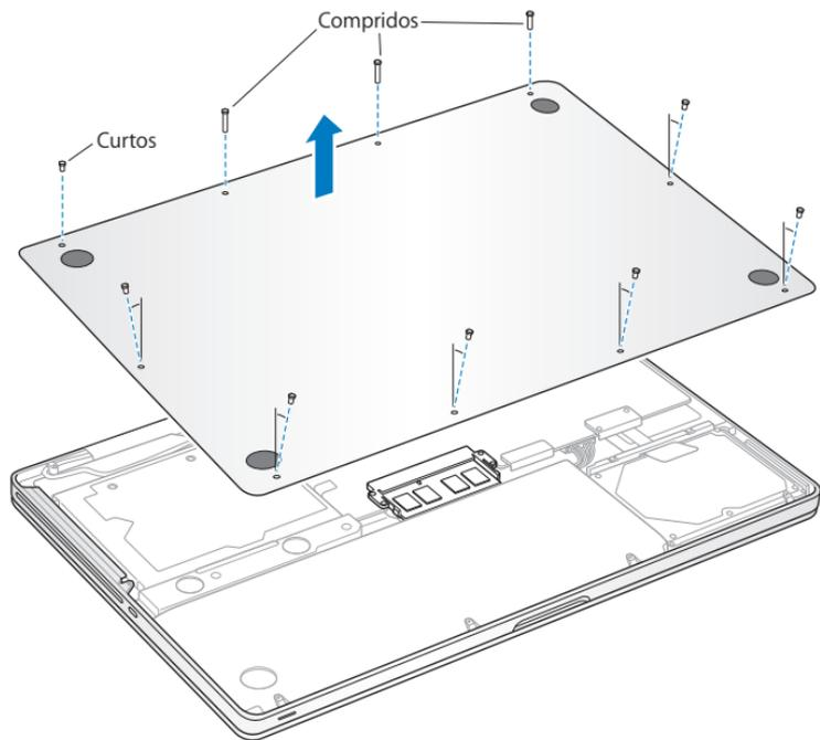
**Importante:** Ao retirar a caixa inferior, está a expor componentes internos sensíveis. Evite tocar em qualquer outra coisa, excepto no conjunto do disco rígido, quando remover ou adicionar uma unidade de disco rígido.
