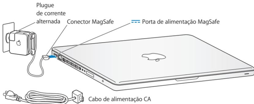
Para prolongar o alcance do seu adaptador de corrente, substitua a ficha da corrente CA pelo cabo de alimentação CA. Primeiro, puxe a ficha da corrente CA para cima para a remover do adaptador de corrente, e em seguida ligue o cabo de alimentação CA ao adaptador de corrente, certificando-se de que se encontra firmemente encaixado.
