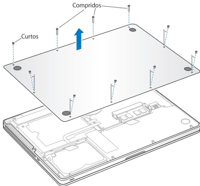
**Importante:** Ao retirar a caixa inferior, está a expor componentes internos sensíveis. Evite tocar em qualquer outra coisa, excepto no conjunto do disco rígido, quando remover ou adicionar uma unidade de disco rígido.
