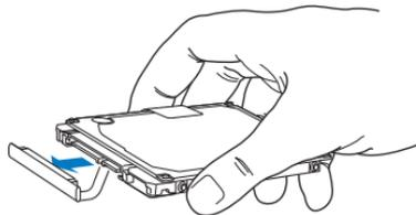
O conector está ligado a um cabo e permanece no compartimento da unidade de disco rígido.
