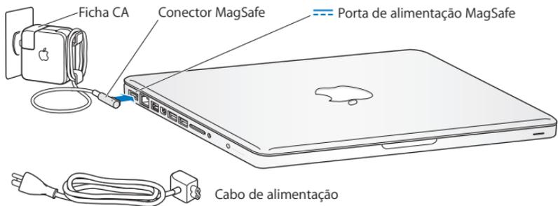
Para prolongar o alcance do seu adaptador de alimentação, substitua a ficha da corrente CA pelo cabo de alimentação CA. Primeiro, puxe a ficha CA para cima, para a remover do adaptador de corrente, e, em seguida, ligue o cabo de alimentação CA ao adaptador de corrente, certificando-se de que se encontra firmemente encaixado.
