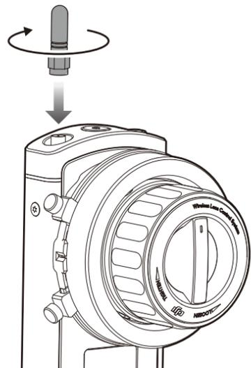
将天线旋转拧入遥控器顶部的安装位置。
