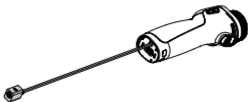
4. 连接外接电源转换器与外接电源（指定 DJI 充电器或智能电池，详见规格列表）。
