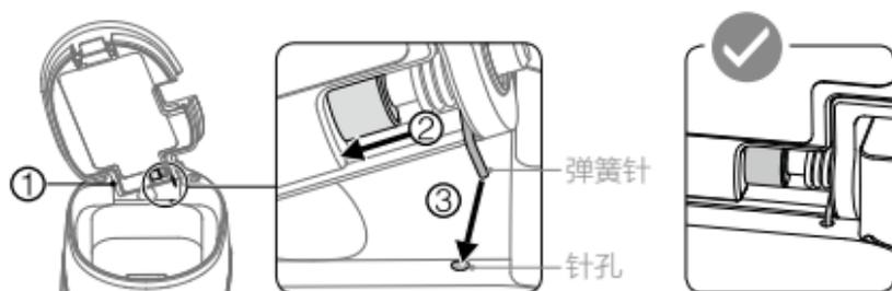
3. 将外接电源转换器装入 Osmo 电池仓，并使其连接线穿过电池仓盖的预留孔，下图为安装示意。
