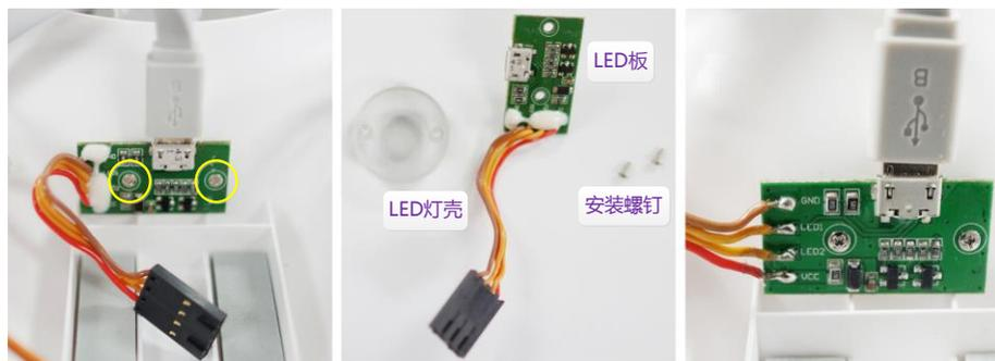
图 4：拆螺钉, 换 LED 板
