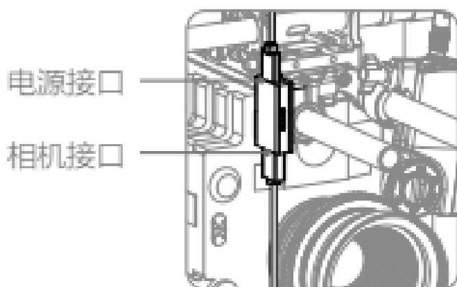
3. 根据相机型号选用对应的相机控制线（另行购买），连接快门控制器相机接口与相机。相机控制线信息与相机设置、连线方式见以下内容。
