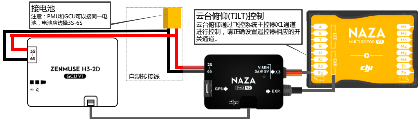
图2 GCU 与 NAZA-M V2 连接示意图
