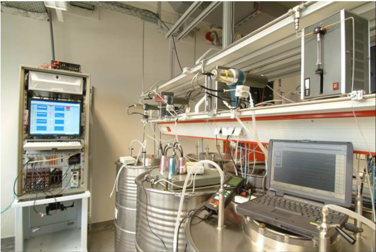
Abbildung 3-1: Kalibrierlaboratorium für Radonmessgeräte des Bundesamtes für Strahlenschutz mit Kalibrierbehältern (Volumen: 0,4 m 3 )/ Radon Calibration Service Laboratory of the Federal Office for Radiation Protection with calibration containers (volume: 0.4 m 3 )
