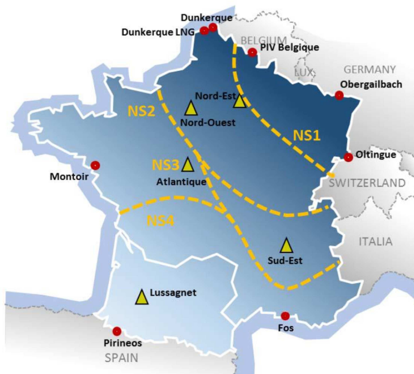
1. attēls. Galvenie darbības ierobežojumi, ko var novērot pārvades tīklā, kad piegādātāji cenšas maksimāli palielināt dabasgāzes ieplūdināšanu no Francijas ziemeļaustrumiem
