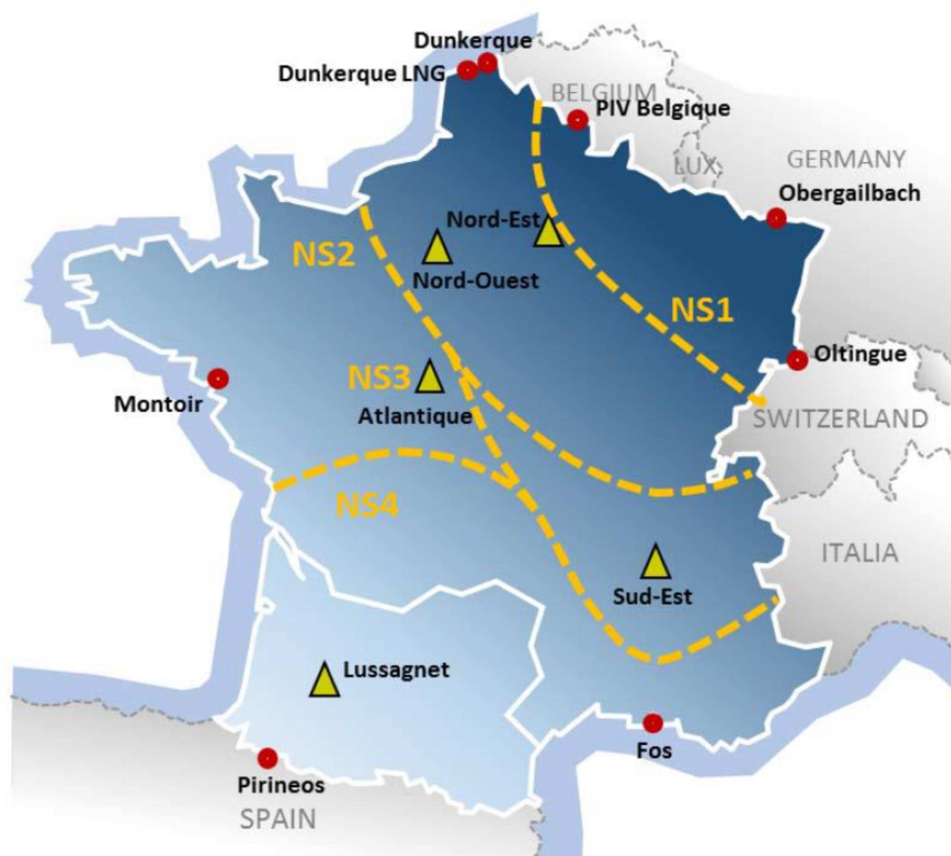
Stampa 1: Limitazzjonijiet operattivi ewlenin li jistgħu jiġu osservati fuq in-netwerk ta' trażmissjoni meta l-fornituri jfittxu li jimmassimizzaw l-injezzjonijiet tal-gass naturali mill-Grigal ta' Franza
