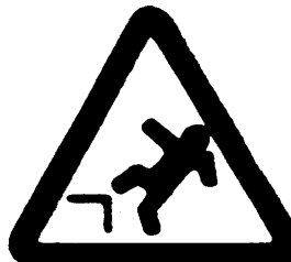
Queda com desnível
