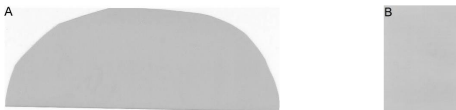
Fig. 3. Filmes radiocrômicos XR-QA2 decompostos na componente red net color dos estudos de dosimetria em mamografia- filme TE pele (A) e radiografia médica- filme TE-pele (B).
