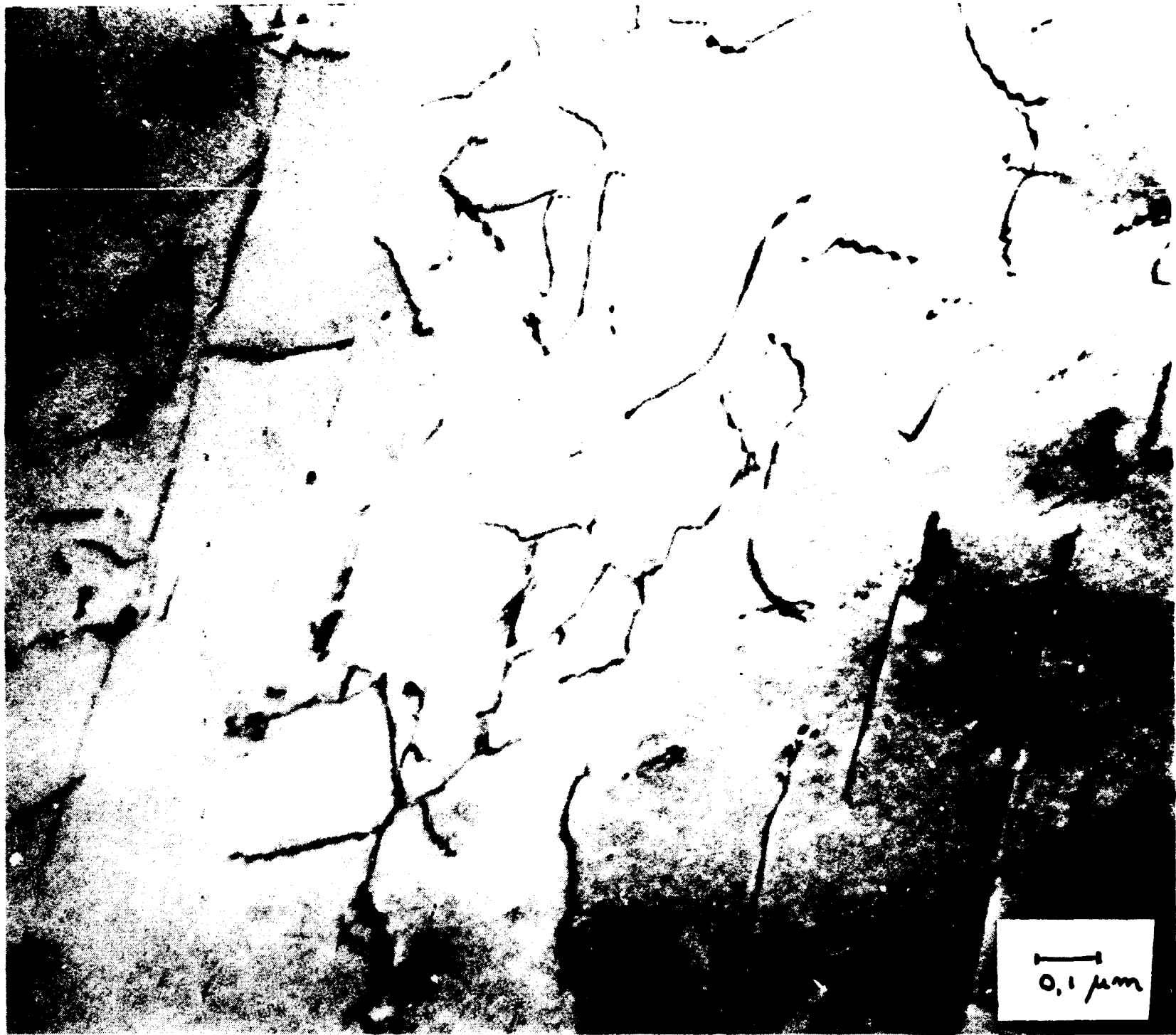
Fig 3. Släckt material, tillstånd A, odeformerat. Transmission 100 000x
