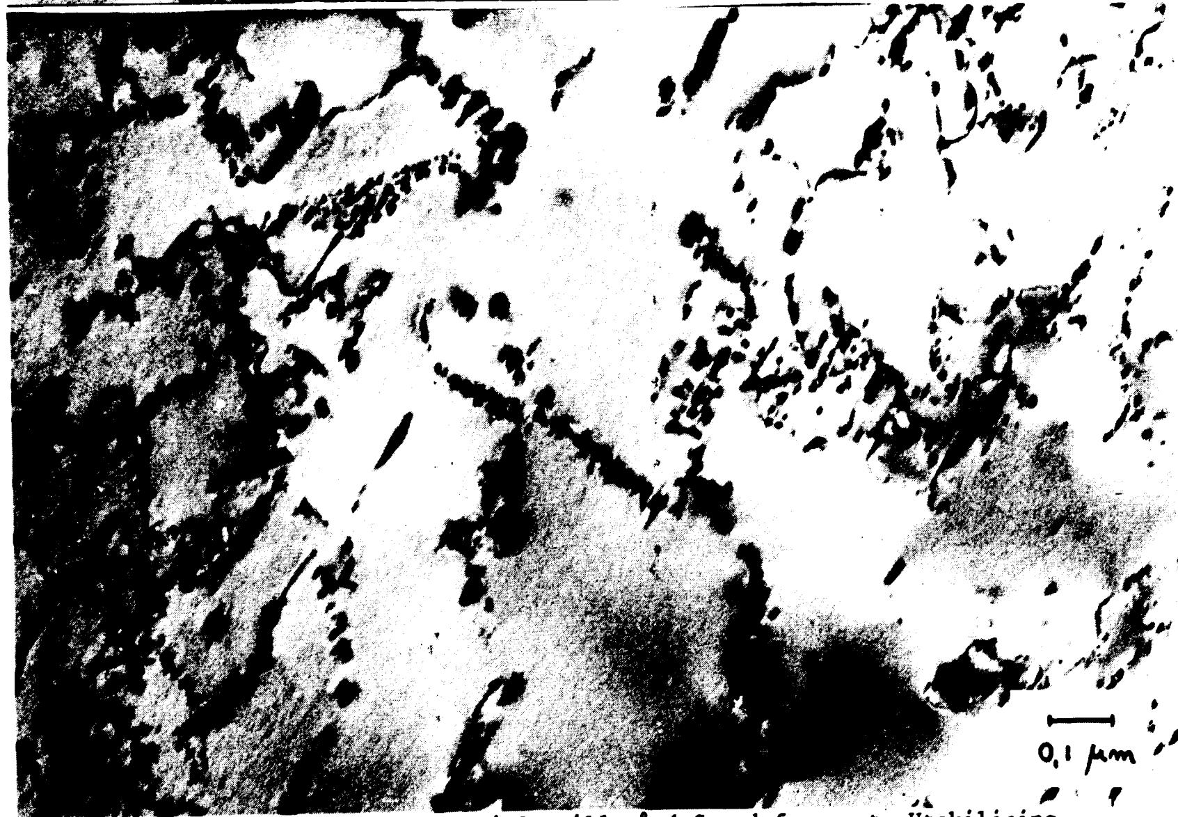
Fig 11. Släckt material, tillstånd C, odeformerat. Utskiljning av TiC. Transmission 100 000x
