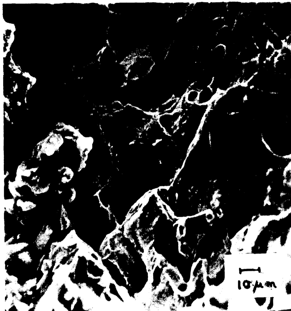
Fig 9. Släckt material, tillstånd C, dragprovat vid 700°C. Interkristallint brott. Svepmikroskop 700x
