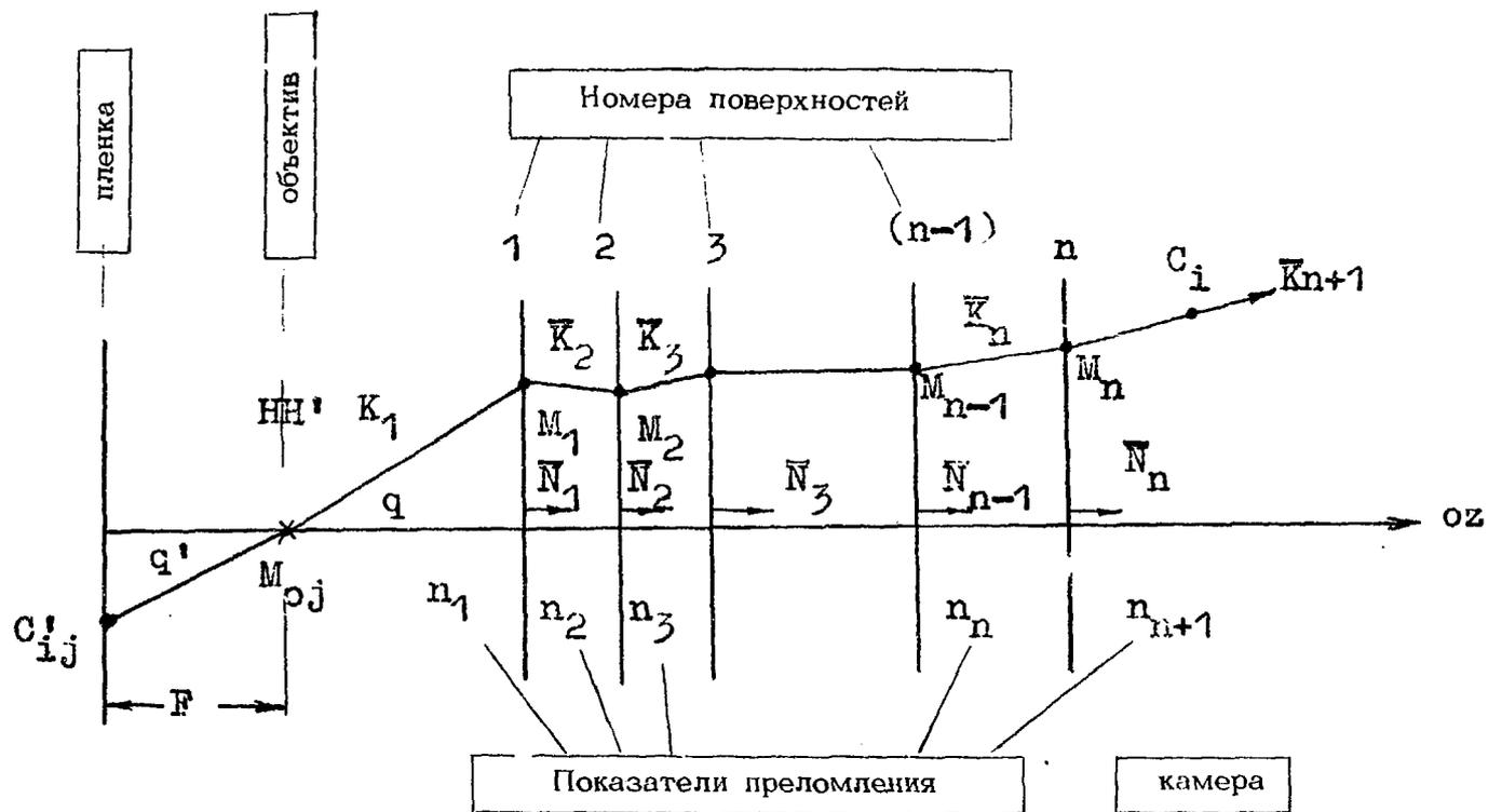
Рис.1. Поперечное сечение оптической системы пузырьковой камеры.
