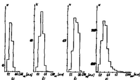
Рис.9. Монте-Карло ( а, б, в ) и экспериментальное ( г ) распределения по среднему отклонению ( $ERR$ ) искр от прямой при разных точностях локализации ( $D$ ) искр в камерах:
