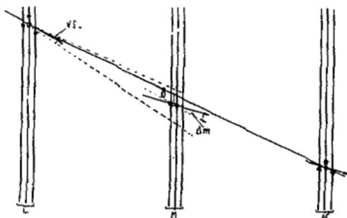
Рис. 4. Схема объединения элементарных треков в полутраектории.
