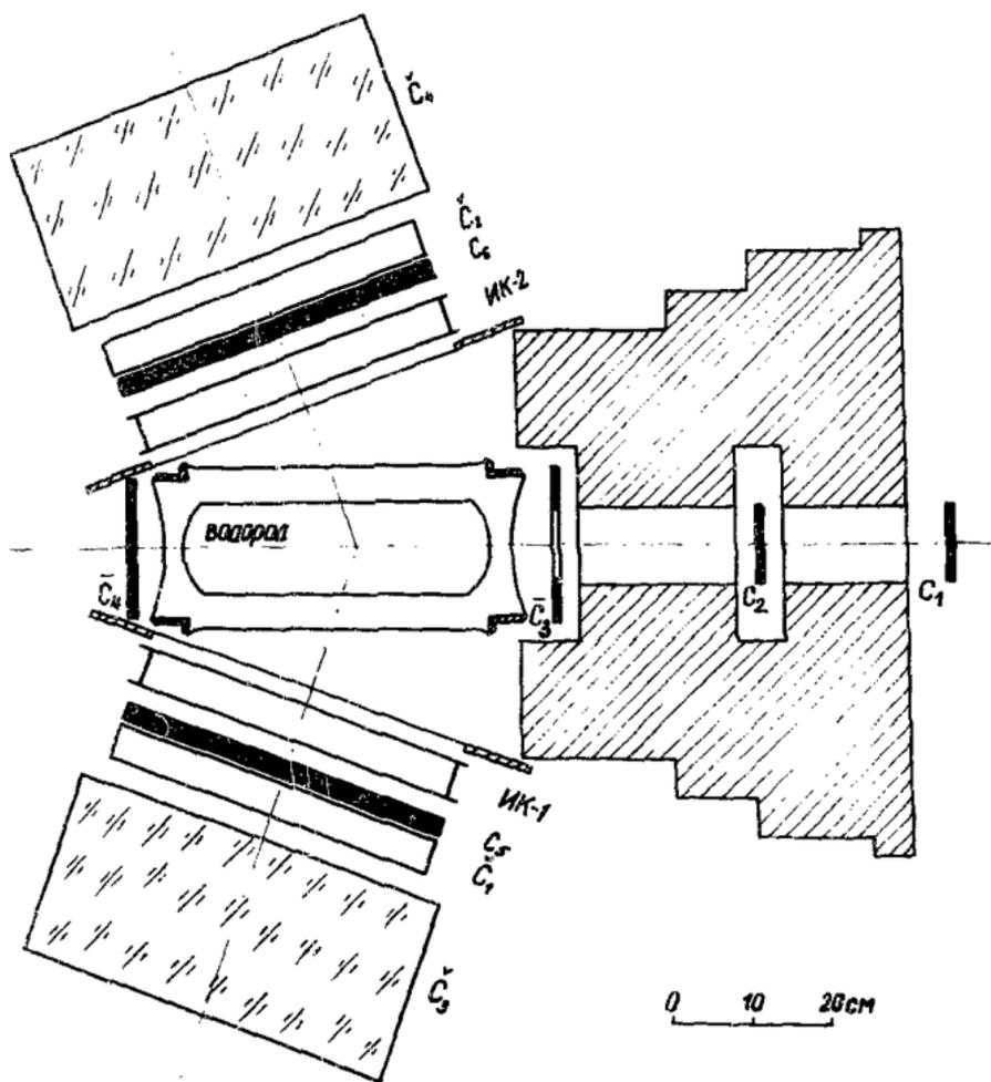
Рис. 1. Схема экспериментальной установки:  $C_1, C_2, C_3, C_4, C_5, C_6$  - сцинтилляционные счетчики;  $Ш_1, Ш_2$  - пороговые водяные черенковские счетчики;  $C_3, C_4, C_5$  - черенковские спектрометры полного поглощения;  $ИК_1, ИК_2$  - искровые камеры.
