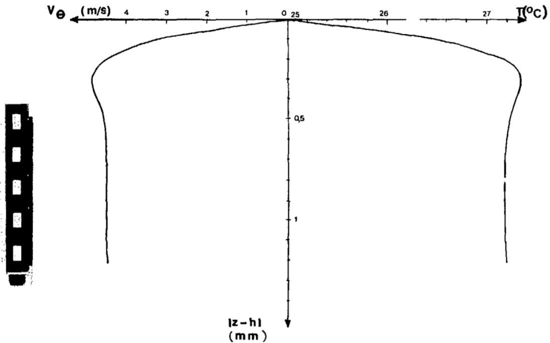
Planche 7 - Vitesse azimutale et température dans la couche d'Ekman.
