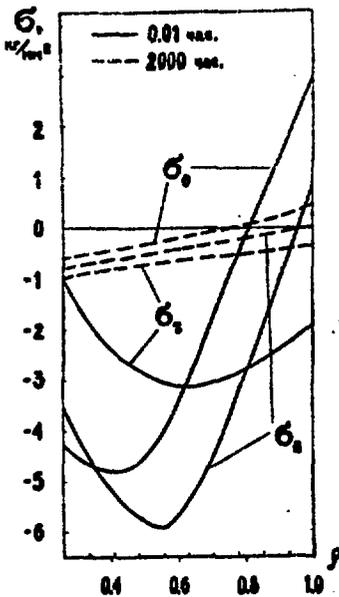
Рис. 4. Распределение напряжений по сечению полого сердечника стержневого твэла.
