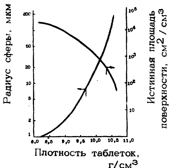
Рис. 7. Зависимость радиуса эквивалентной сферы и истинной поверхности от плотности топлива [12]
