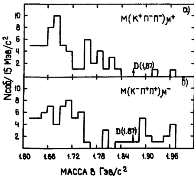
Рис. 4. Распределения по эффективным массам систем  $K\pi\pi$  сопровождаемых мюоном а/  $(K^+\pi^-\pi^-)\mu^+$ , б/  $(K^-\pi^+\pi^+)\mu^-$ .
