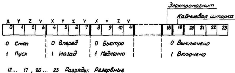
Рис. 4. Значения отдельных разрядов параллельного выходного регистра
