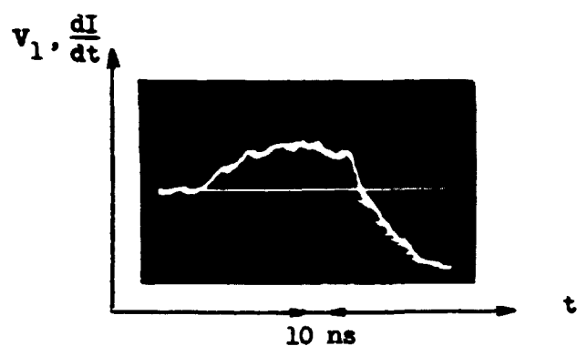
5 a : Addition des signaux de sonde magnétique et du diviseur Haefely
