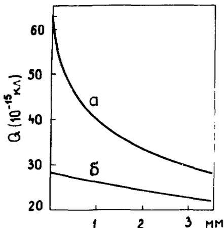
**Рис. 7.** Кривые корреляции между пробегом частицы в секции, где произошла остановка, и сигналами в двух предыдущих секциях.
