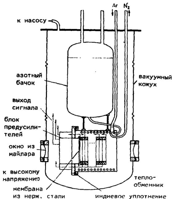
Рис. 2. Схема жидкоаргоновой ионизационной камеры.
