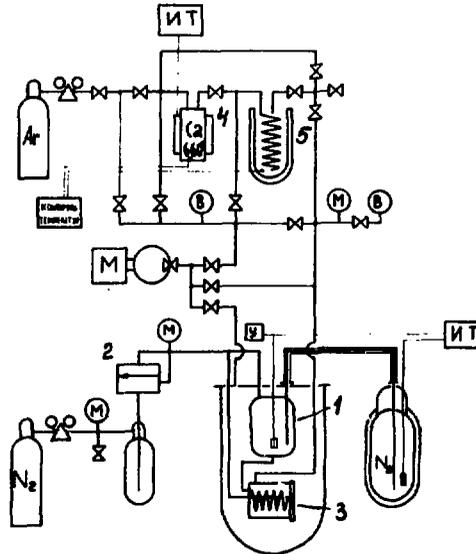
Рис. 3. Схема установки с жидкоаргоновой ионизационной камерой: 1 - азотный бачок; 2 - стабилизатор давления; 3 - камера; 4 - реактор с кальциевой стружкой; 5 - вымораживающая ловушка; М - манометры; В - вакуумметры; У - источник тока.
