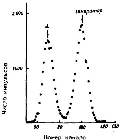
Рис. 4. Спектр импульсов  $\alpha$ -частиц от источника  $^{241}\text{Am}$ .
