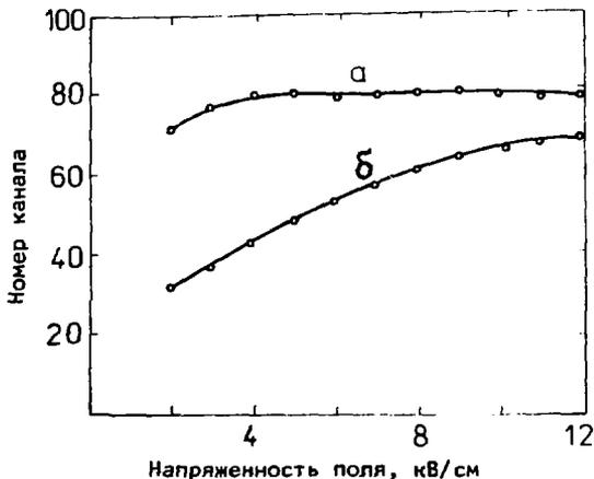
Рис. 5. Амплитудные характеристики жидкоаргоновой ионизационной камеры для  $\gamma$ -квантов  $/\alpha/$  и  $\alpha$ -частиц  $/\beta/$ .
