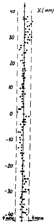
Рис.9. Данные сканирования тестовой прямой с предварительной коррекцией по таблице.
