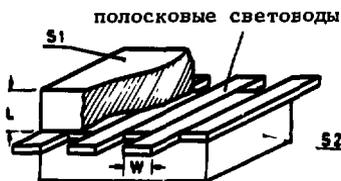
Рис.1. Конструкция сцинтилляционного счетчика.
