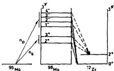
Рис. 6. Схема  $\alpha$ -распада уровней  $^{96}\text{Mo}$ , образующихся при взаимодействии  $\alpha$ - и  $p$ -нейтронов с  $^{95}\text{Mo}$ . Стрелками показаны разрешенные  $\alpha$ -переходы.
