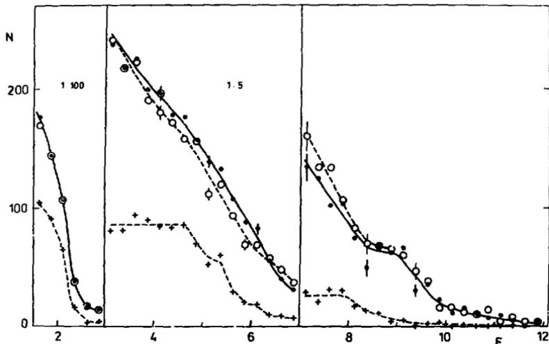
Рис. 1. Спектры частиц из образца 1: ● - спектр частиц из реакции  $^{95}\text{Mo}(p,\alpha)$  вместе с фонами /эффект+фон/; ○ - спектр фона при энергии протонов ниже порога реакции  $^{7}\text{Li}(p,n)$  на 10 кэВ; + - спектр фона при неработающем ускорителе. На осях: N - число отсчетов в интервале 250 кэВ, E - энергия частиц в МэВ.
