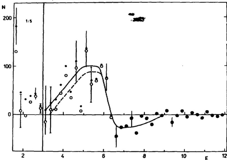
Рис. 2. Спектр частиц из реакции  $^{95}\text{Mo}(p, \alpha)^{92}\text{Zr}$ , измеренный на образце 1:  $\bullet$  и сплошная кривая - фон определен по первому способу,  $\circ$  и пунктирная кривая - фон определен по второму способу.
