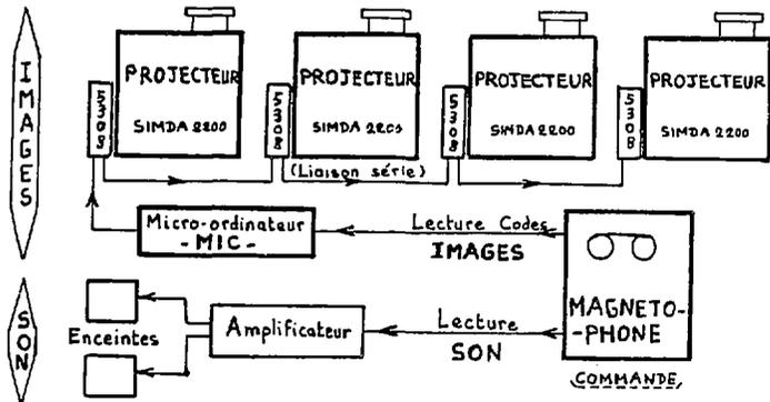
Le système utilisé au GANIL est le suivant :
