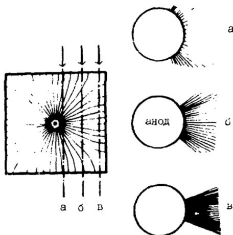
Рис. 12. Схема силовых линий электрического поля в ИСТ.
