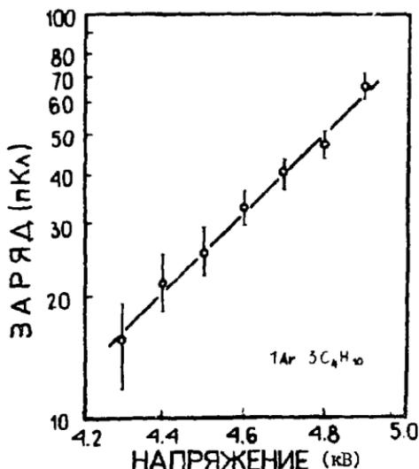
Рис. 3. Амплитудная характеристика СГС разряда в стримерных трубках.
