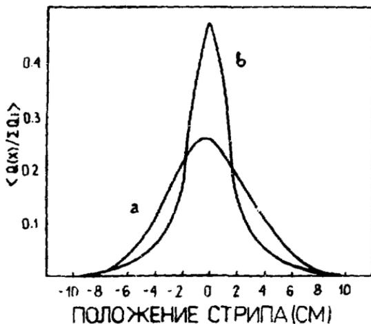
Рис. 8. Распределения индуцированного заряда со стороны профиля (а) и со стороны крышки (б), усреднённые по 300 пробам.
