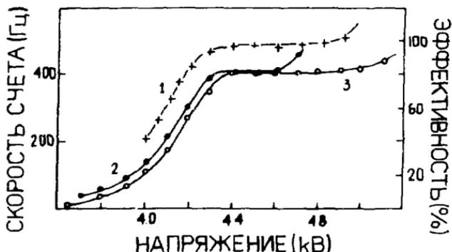
Рис. 5. Кривая эффективности (1) и счётные характеристики ПСТ, заполненных смесями аргона с изобутаном в пропорции 1:2 (2) и 1:3 (3).
