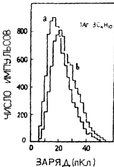
Рис. 9. Распределение значений суммы зарядов со всех координатных полосок  $\Sigma Q_i$ ,  $i=1 \div 12$  для плоскости, расположенной со стороны профиля (а) и со стороны крышки (б), при напряжении 4,7 кВ.
