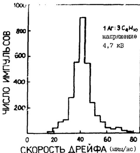
Рис. 11. Распределение значений скорости дрейфа, зарегистрированных в промежутке  $0,5 \pm 4,5$  мм.
