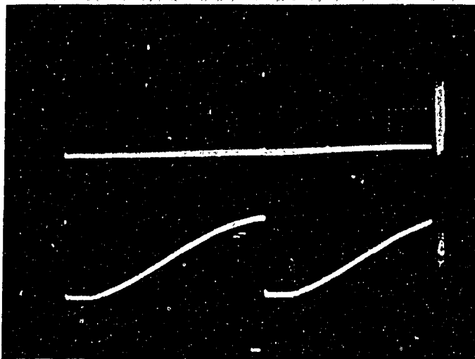
第8図 SCRアノードパルス波形
