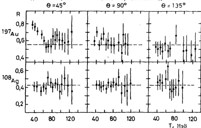
Рис. 7. Отношение инвариантных сечений  ${}^6\text{He}$  и  ${}^6\text{Li}$  в зависимости от энергии фрагментов. Показанные ошибки включают неопределенности в абсолютной нормировке. Пунктирные линии получены из модели слияния в предположении, что спектры нейтронов и протонов одинаковы.
