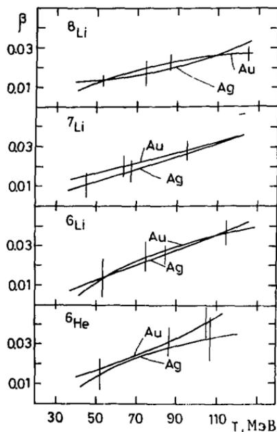
Рис.4. Скорости /в единицах скорости света/ источников <sup>6</sup>He, <sup>6,7,8</sup>Li для ядер-мишеней Ag и Au в зависимости от кинетической энергии фрагментов в лабораторной системе  $\theta = 90^\circ$ . Кривые соответствуют среднему значению  $\beta$ , вертикальные линии - разность между средними значениями и максимальной /минимальной/ величиной.
