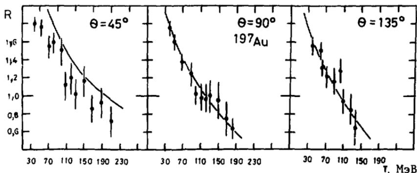
Рис.8. Отношение спектров  ${}^7\text{Li}$  и  ${}^6\text{Li}$  для мишени Au. Сплошной линией представлены термодинамические расчеты, отнормированные при  $T = 100$  МэВ и  $\theta = 135^\circ$ .
