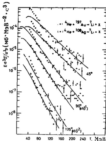
Рис. 2. Инвариантные сечения испускания  ${}^7\text{Li}$  при взаимодействии  ${}^4\text{He}$  с  $\text{Ag}$  и  $\text{Au}$ . Абсолютная ошибка в определении сечений на рисунке не показана и составляет около 20%. Сплошными линиями даны предсказания модели файерстрик, отнормированные при  $T = 100$  МэВ.
