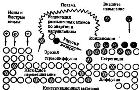
Рис. 7. Процессы, ответственные за массоперенос распыленных атомов вблизи границы раздела плазма — конструкционный материал
