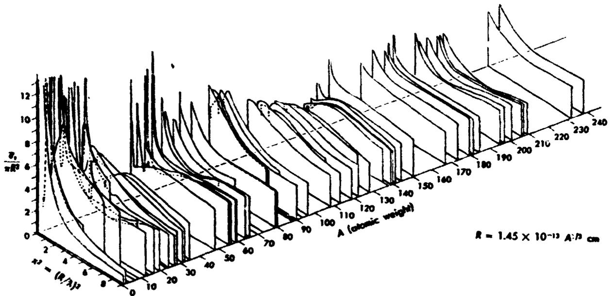
Fig. 6 - Seção de choque total para nêutrons em função da energia e do número de massa. A energia é dada como  $x^2 = (R/\lambda)^2$ , onde  $\lambda$  é o comprimento de onda de Broglie dos nêutrons. /23/
