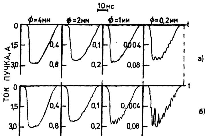
Рис. 4. Серия осциллограмм тока пучка электронов за коллиматором при разных значениях диаметра щели  $\phi$  при  $D = 10$  мм и напряжении на диоде 10 кВ:
