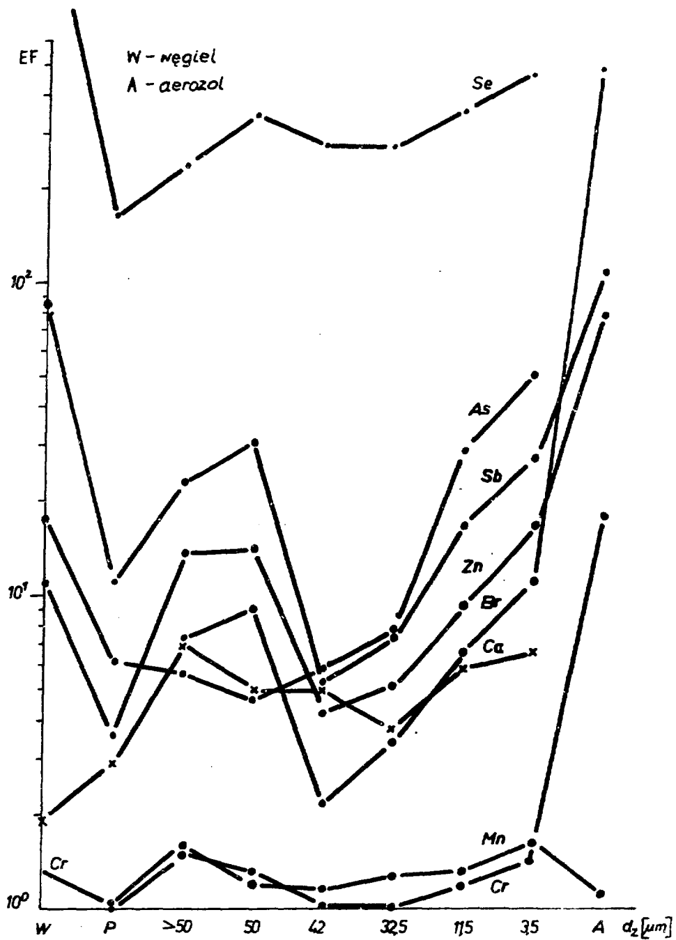
Rys.1 Zależność współczynników wzbogacenia od klas ziarnowych dla II strefy elektrofiltru.
