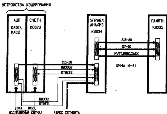
Рис.1. Базовый комплект анализатора МАК-4.
