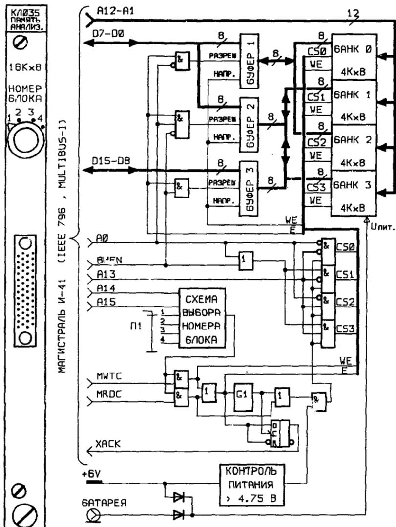
Рис. 3. Передняя панель и блок-схема памяти К1035.
