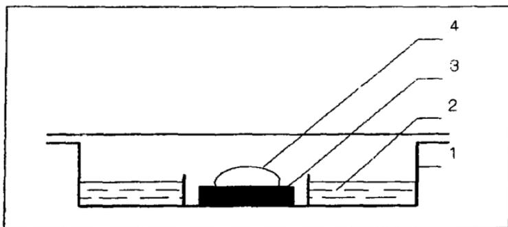
Рисунок 3. Ванна для проведения сорбции радионуклидов на ММС.
