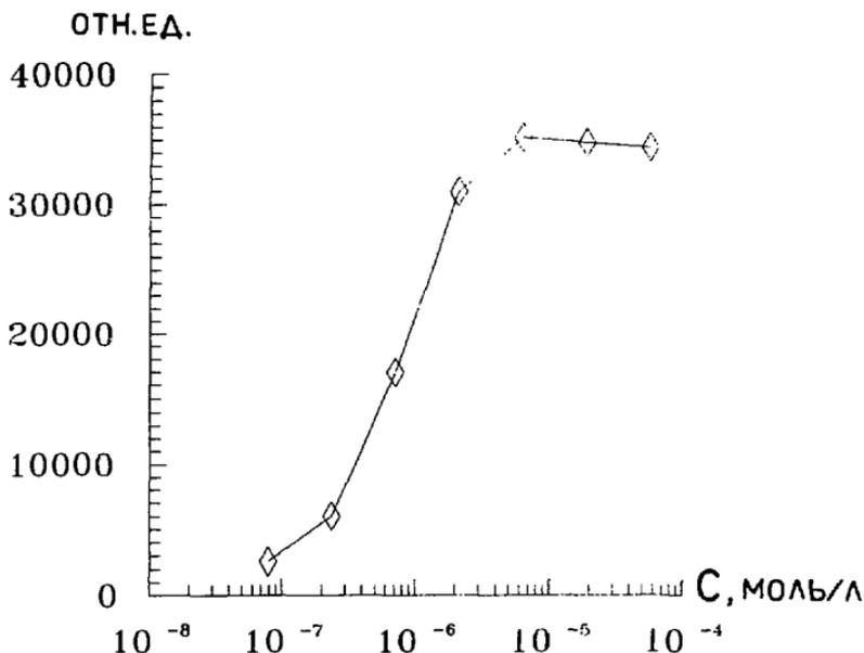
Рисунок 5. Зависимость сорбции ионов  $\text{Eu(III)}$  на ММС стеариновой кислоты от концентрации раствора  $\text{Eu}(\text{NO}_3)_3$ ,  $\text{pH} = 6,2$ ; время сорбции 4 часа.
