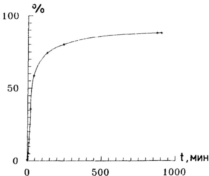
Рисунок 4. Сорбция тулия из капли раствора, содержащего 160 мКи  $^{167}\text{Tm}$  (рН = 6,2).
